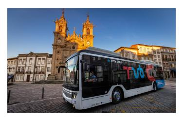
Estas viaturas possuem baterias de lítio, em estado sólido, com capacidade de armazenamento de energia elétrica de 314 kWh, que permitem realizar uma jornada completa de trabalho, de cerca de 14 horas de operação, com um único carregamento.
